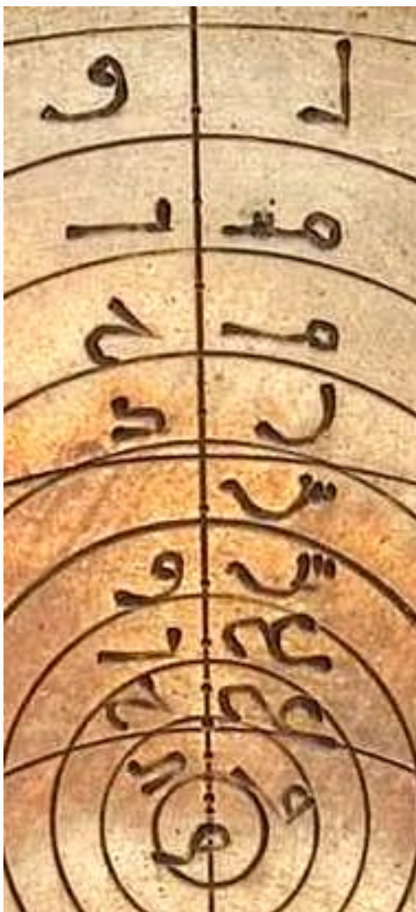
Инв. 47632. Астролябия из Сирии конца IX века НЭ. Шкала альмукантаратов (параллельных горизонту малых кругов небесной сферы) на тимпане 2а. Числа справа налево и сверху вниз 36, 42, 48, 54, 60, 66, 72, 78, 84, 90 градусов.
